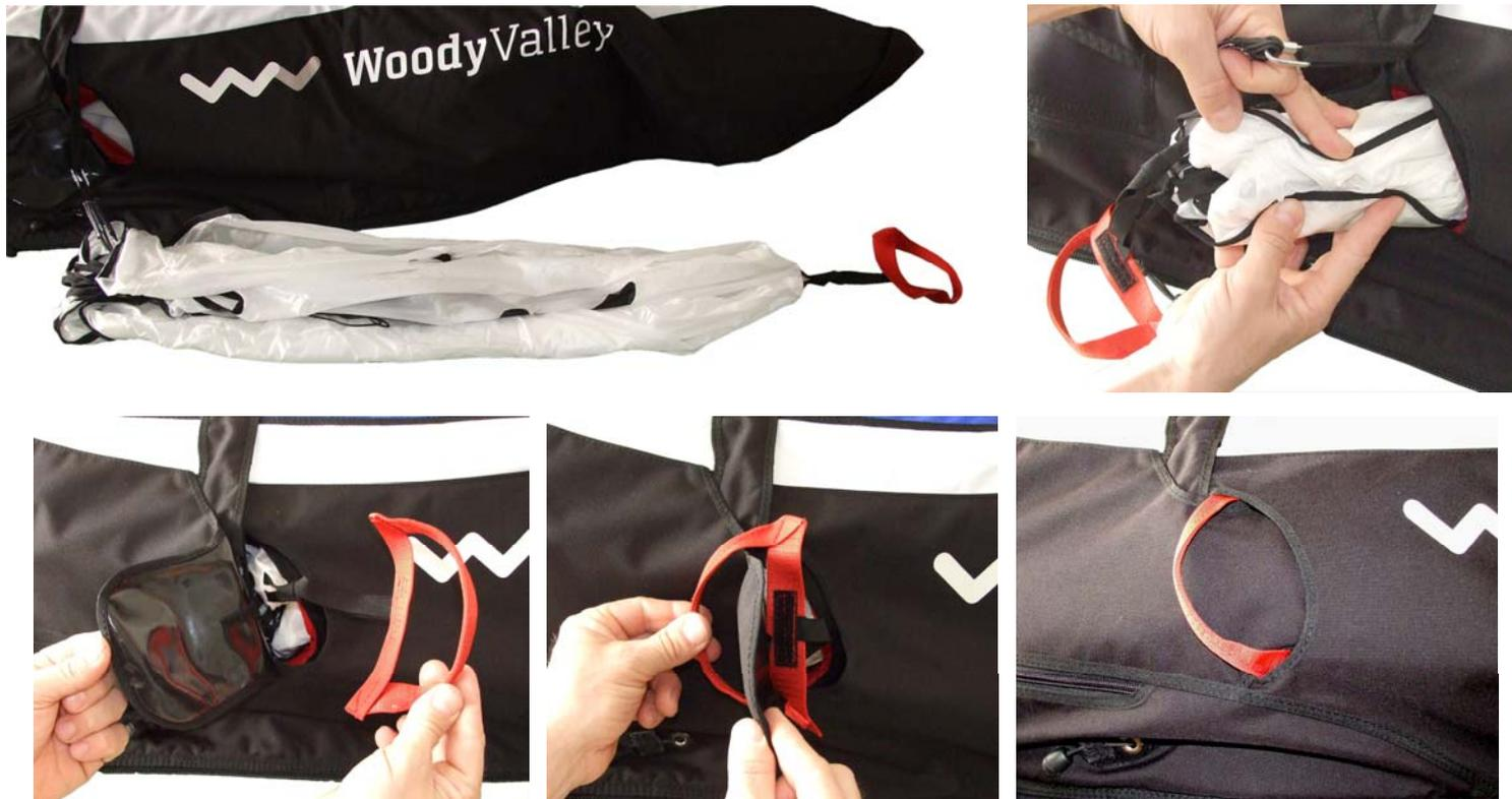
Dieses System ermöglicht es Ihnen, den Bremsschirm herauszuziehen und während der Landephase fest in der Hand zu halten, und dann genau im richtigen Moment zu öffnen. Wenn Sie eine sofortige Öffnung wünschen, lassen Sie den Griff einfach sofort nach dem Herausziehen los.
