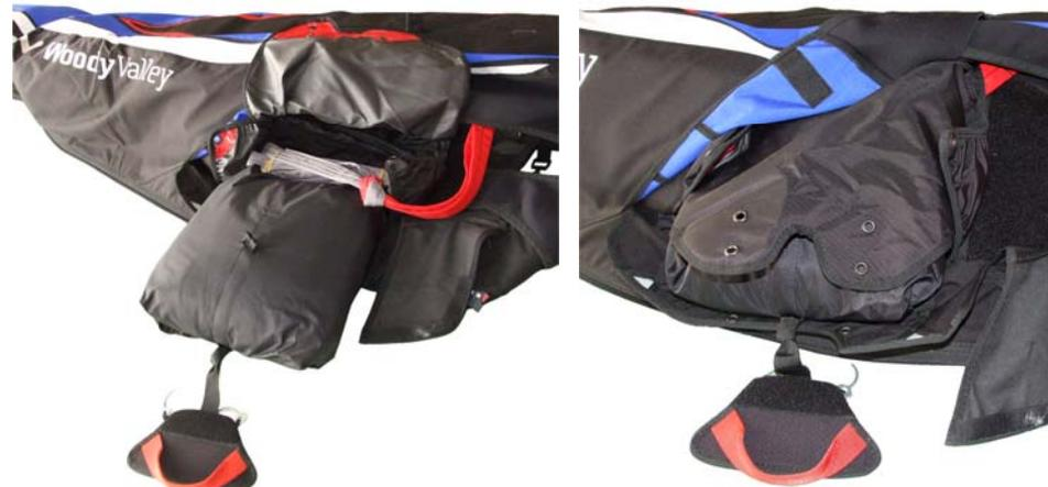
Führen Sie eine dünne Schnur (1 bis 2 mm Durchmesser) in jede elastische Schlaufe ein, mit deren Hilfe Sie dann den Container schließen können. Die elastischen Schlaufen in die beiden kleineren Ösen einführen, die am besten den Maßen Ihres Rettungsschirms entsprechen. Befolgen Sie die Abfolge zum Schließen der beiden Ecken, die Sie den folgenden Zeichnungen/Fotos entnehmen können.
